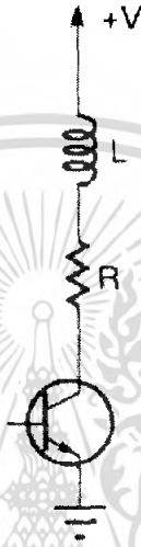
รูปที่ 2.30 วงจรเสมือนของขดลวดที่ต่อกับทรานซิสเตอร์
