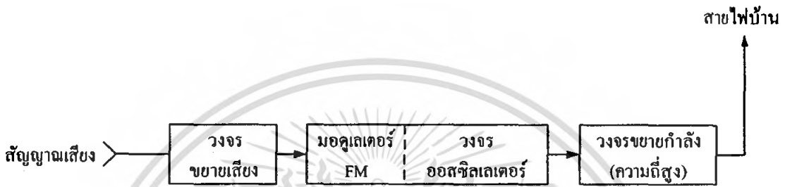
รูปที่ 4.1 แผนผังเครื่องส่ง FM อย่างง่าย
