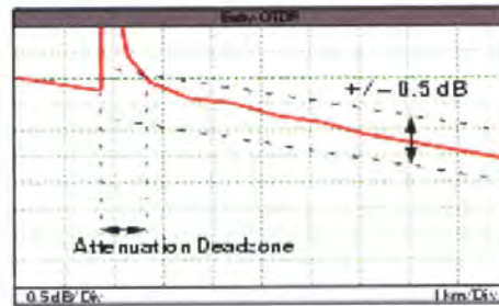
รูปที่ 2.33 แสดงลักษณะกราฟของ Attenuation Deadzone
