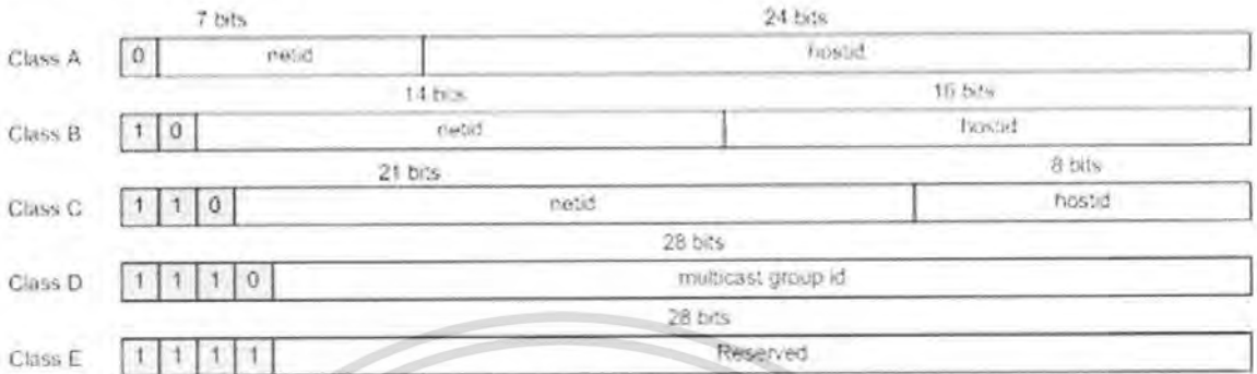
รูปที่ 2.6 การกำหนด IP Address ในคลาสต่างๆ
