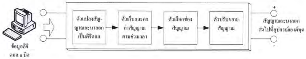
รูปที่ 2.29 โค้ดแกรมของหน่วยเอาต์พุตแบบอนาล็อก
