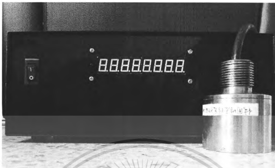
รูปที่ 4-12 รูปแสดงเครื่องคั้นหาวัตถุแขวนลอยได้นำด้วยคลื่นอัลตราโซนิก
