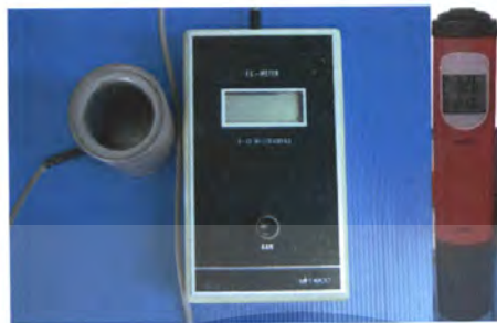
ภาพที่ 1 เครื่องวัดความเข้มข้นของสารละลาย (EC meter) และเครื่องมือวัดความเป็นกรด-ด่าง (pH meter)
