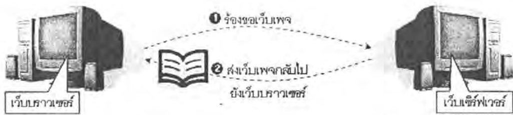
รูปที่ 2.1 แสดงการทำงานของเว็บเพจแบบปรกติ
