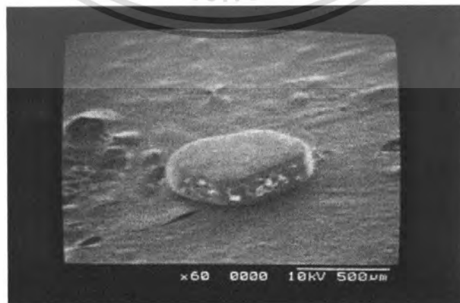
รูปที่ 4.2(a) สภาพพื้นผิวด้านข้างของดินสักระสุนปืน 9mm Luger JHP Sellier&Bellot
