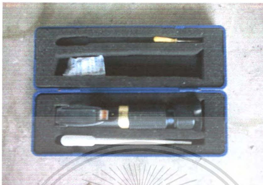
ภาพผนวกที่ 7 เครื่องวัดค่าความหวาน "Hand refractometer" (°brix)
