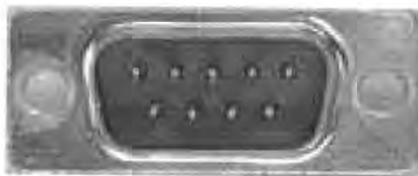
รูปที่ 2.4 RS-232 คอนเนคเตอร์แบบ DB9 ที่หลังคอมพิวเตอร์จะเป็นตัวผู้
