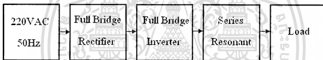
รูปที่ 3.1 แสดงบล็อกไดอะแกรมของวงจรกำลัง
