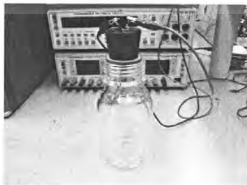
รูปที่ 4.4 การทดสอบแอมโมเนียทดสอบโดยใช้ขวดทดลองขนาด 280 ซีซี
