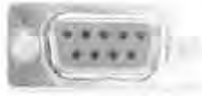
รูปที่ 2.26 พอร์ตอนุกรมของอุปกรณ์ภายนอก DB9 ตัวเมีย (Female)
