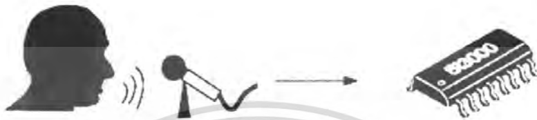
รูปที่ 3.6 ไอซี SI 3000 รับสัญญาณเสียงจากการพูดทางไมโครโฟน
