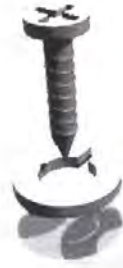
รูปที่ 5.2 : ใสแหวนสปริงคั่นระหว่างเนื้อไม้และสกรู ที่มา : เพิ่มภาพส่วนบุคคล น.ส.อาทิตยา ทวีพัฒนะพงศ์ พ.ศ. 2550
