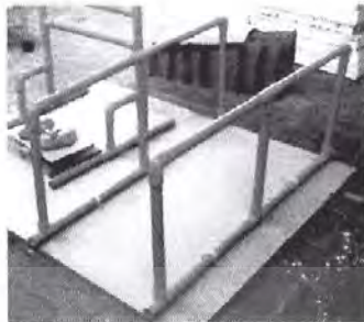
รูปที่ 1.25 : หุ่นจำลองขนาด 1:1 ด้วยท่อพีวีซี และไม้อัด แบบที่ 1.1 ที่มา : แพ้มภาพส่วนบุคคล น.ส.อาทิตยา ทวีพัฒนพงษ์ พ.ศ. 2550
