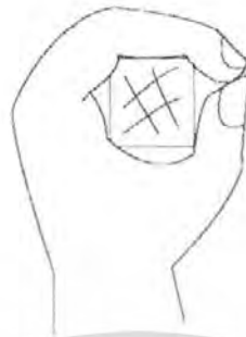
รูปที่ 5.5 : เส้นผ่าศูนย์กลางของราวจับต้องมีขนาดอยู่ระหว่าง 19-38 มิลลิเมตร ที่มา : ข้อกำหนดด้านความปลอดภัยของสนามเด็กเล่น
