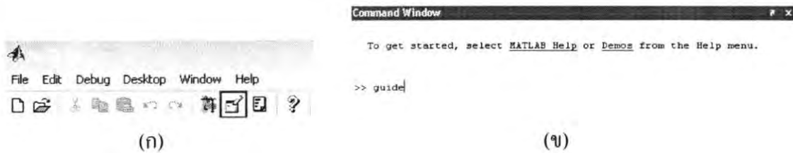
รูปที่ 3.2 วิธีการเปิด GUIDE (ก) กดปุ่ม (ข) พิมพ์ guide ลงบน Command Window
