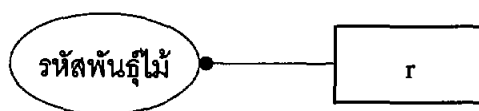
รูปที่ 2.11 สัญลักษณ์ของ Mandatory role constrains
