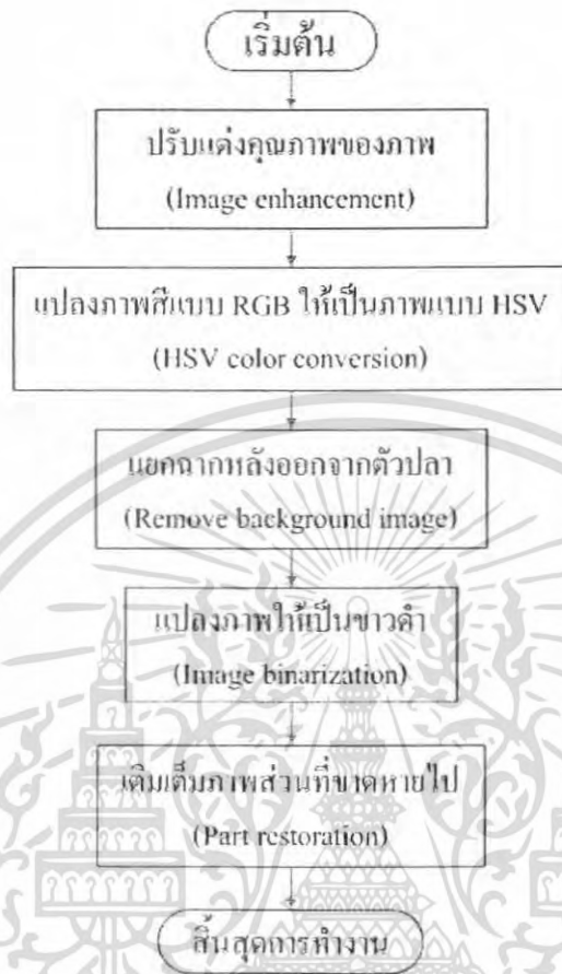
รูปที่ 3.17 ลำดับการประมวลผลภาพเพื่อระบุตัวปลาในการทดลอง
