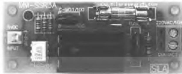
รูปที่ 2.6 โซลิตเตทรีเลย์ (Solid State Relay)
