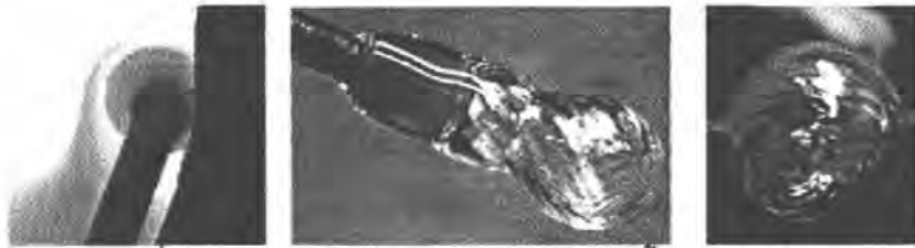
ภาพที่ 219 การนำแก๊วเข้าไฟและการหมุนแก๊วของชิ้นงานขนาดใหญ่
