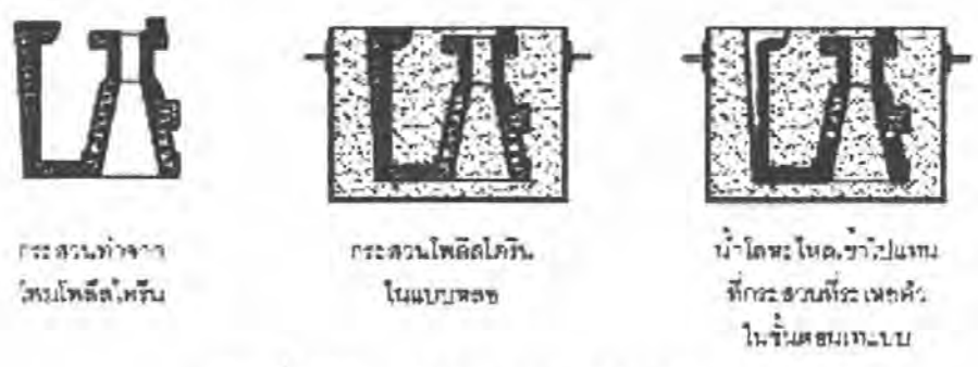
ภาพที่ 135 การหล่อโลหะแบบหล่อพิมพ์หาย
