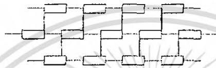
ภาพที่ 2 - 64 ภาพแสดงโมเลกุลการเกาะตัวแบบต่อแขนยาวออกเป็นแบบลูกโซ่ของเทอร์โมพลาสติก
