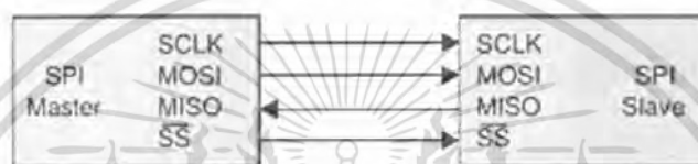
รูปที่ 3.10 การรับส่งข้อมูลระหว่าง Master กับ Slave
