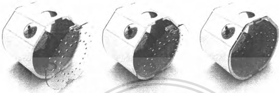
ภาพที่ 111 การปิดฝาของแต่ละห้องด้วยการใช้ตัว Snap ที่ด้านบนและล่างของฝา
