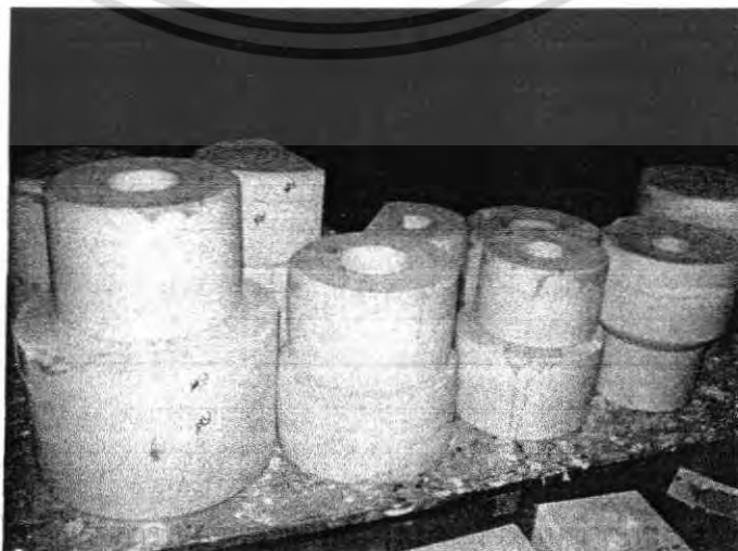
ภาพที่ 4.1-4 Block mould ที่นำไปหล่อน้ำดิน
