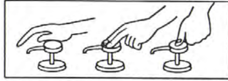
ภาพแสดงท่าของนิ้วชี้สำหรับเปิด-ปิดน้ำยาล้างมือ 36 มม. ซึ่งเป็นขนาดที่สอดคล้องกับ 2 นิ้วข้อมือ
