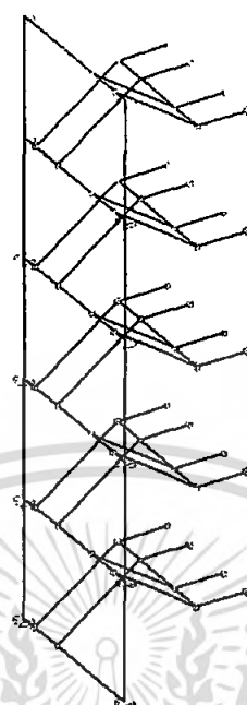
รูปที่ 4.121 โครงสร้างอาคารพักอาศัยหกชั้นเฉพาะส่วนบันได Dog Leg (ภาพสามมิติ)
