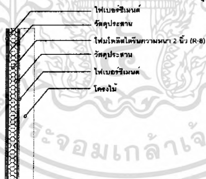
รูปแบบที่ 1 โฟมโพลีสไตรีนบน โครงสร้างไม้ ใช้วัสดุปิดผิวด้านนอกฉนวน
