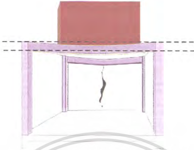
รูปที่ 2.6 แสดงภาพผนังแตกร้าวแนวตั้งเนื่องจากคานเหนือผนังแอ่นตัว (ชเนศ วีระศิริ, 2548)
