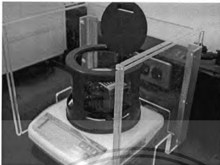
รูปที่ 3.9 เครื่องวัดความหนาแน่นแบบอเล็กทรอนิกส์ รุ่น MD-200S
