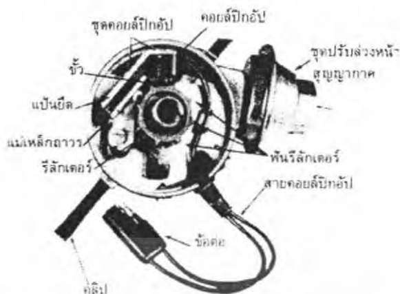
รูปที่ 4-8 ชิ้นส่วนต่างๆในจานจ่ายแบบหนึ่งของระบบจุดระเบิดอิเล็กทรอนิกส์
