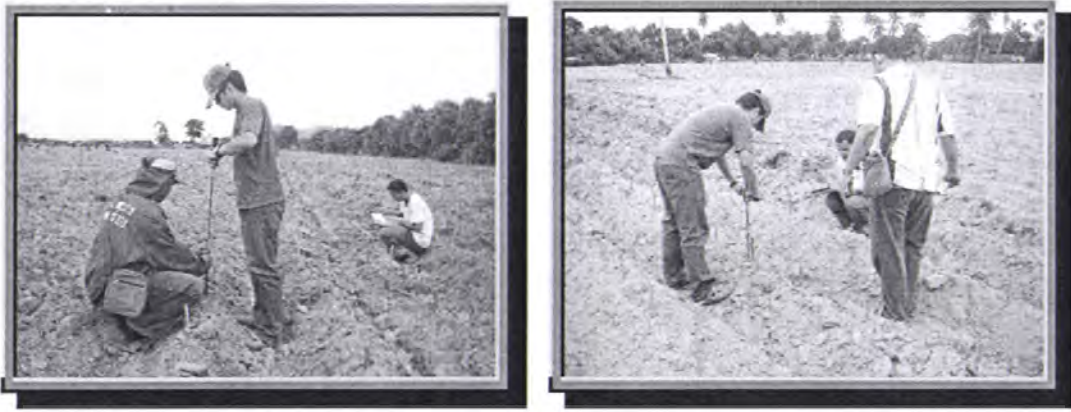
รูปที่ 3.2 การกวัดค่าความหนาแน่นของดินจากแปลงปลูกมันสำปะหลัง อำเภอบ้านฉาง จังหวัดระยอง
