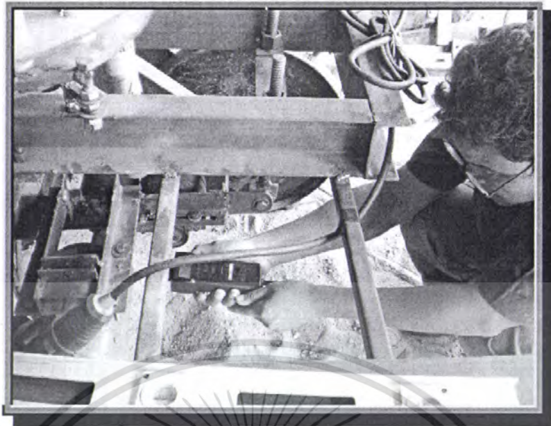
รูปที่ 4.13 แสดงการวัดรอบก่อนทำการทดสอบ
