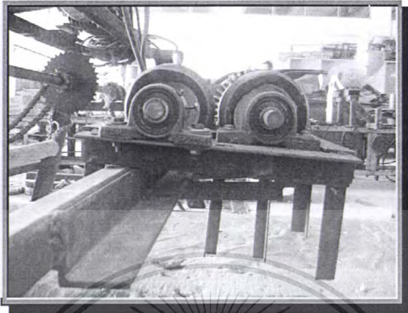
รูปที่ 3.10 แสดงชุดปิ้งท่อนพันธุ์ที่เสร็จสมบูรณ์ด้านข้าง
