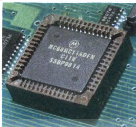
ภาพที่ 2.10 ตัวอย่างไมโครคอนโทรลเลอร์แบบ CISC ของบริษัทโมโตโรล่า
