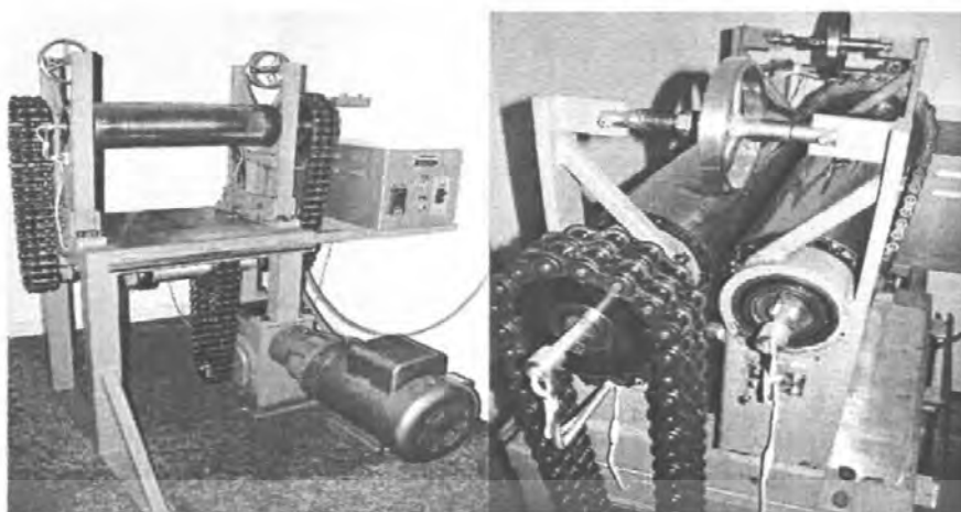
รูปที่ 3.3 เครื่องผสมแบบอัดรีดชนิด 2 ลูกกลิ้ง
