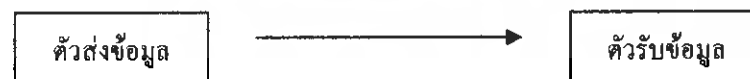
รูปที่ 2.11 แสดงการส่งข้อมูลแบบทิศทางเดียว (Simplex)
