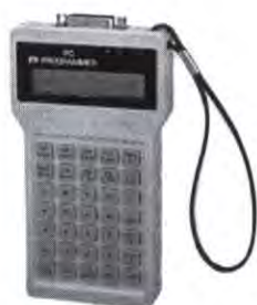
รูปที่ 2.5 แสดงตัวป้อนโปรแกรมแบบมือถือ (Hand Held Programmer)
