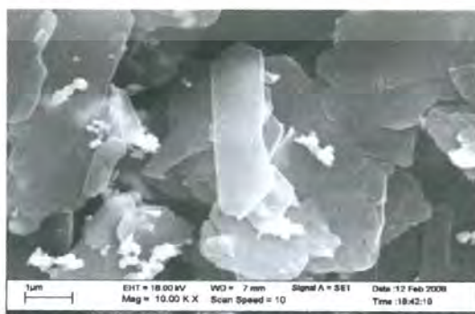
รูปที่ 4.8 อนุภาคของซิงค์กลีเซอโรเลตที่เตรียมจากกลีเซอรอลบริสุทธิ์กับซิงค์ออกไซด์
