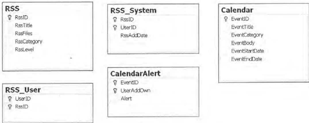
รูปที่ 3.24 โครงตารางเกี่ยวกับ โมดูลคอนเทนท์ และ โมดูลปฏิทิน
