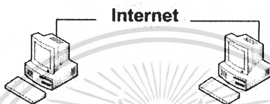
รูปที่ 2.18 การใช้งาน VoIP แบบ PC-to-PC
