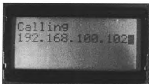
รูปที่ 4.50 ผลหน้าจอ LCD ในโหมดทำการติดต่อของทางฝั่งส่ง โดยทำการติดต่อไปยังปลายทางหมายเลข IP 192.168.100.102
