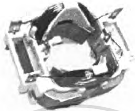
รูปที่ 2.3 แสดงขดลวดที่พันขั้วแม่เหล็ก
