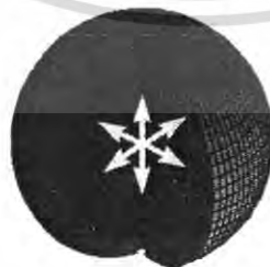
รูปที่ 3.2 การกระจายแบบ Isotropic เป็นต้นเหตุของการสูญเสียในอากาศว่าง
