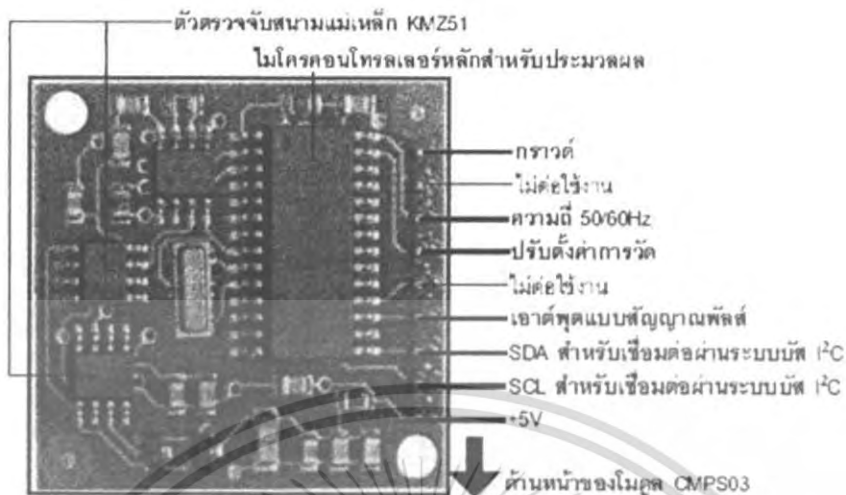
รูปที่ 3-8 ขาที่ต่อใช้งาน เข็มทิศแบบดิจิทัล CMPS03[2]
