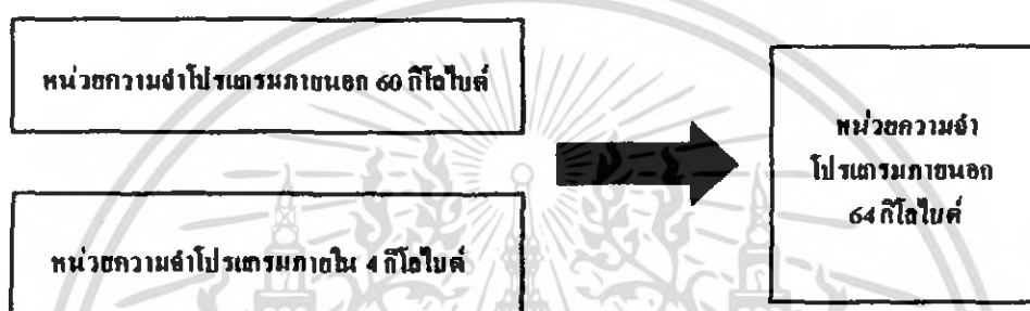
รูปที่ 2-12 การเลือกใช้หน่วยความจำโปรแกรมของไมโครคอนโทรลเลอร์เบอร์ AT89C51
