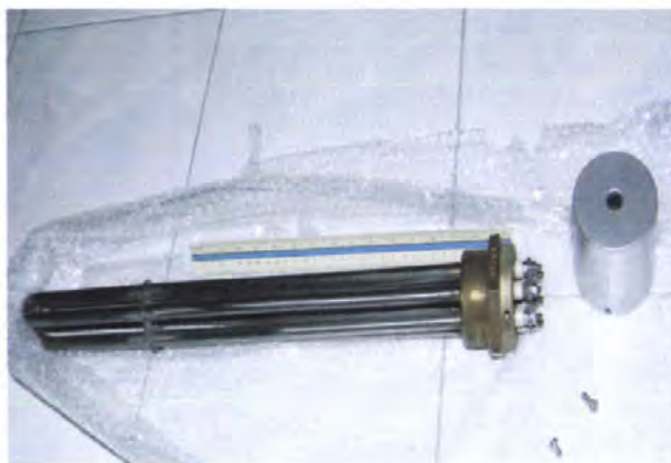
รูปที่ 7.16 รูปฮีตเตอร์ ชนิด Immersion Heater
