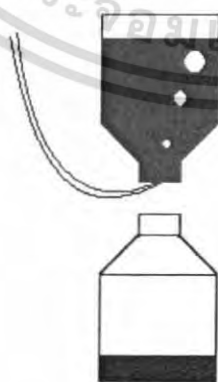
รูปที่ 3.12 รูปแสดงการวัดค่าปริมาตรแก๊ส โดยการแทนที่ของน้ำ
