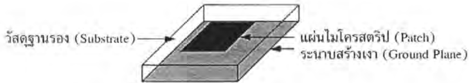
รูปที่ 2.6 รูปแบบโครงสร้างโดยทั่วไปของสายอากาศไมโครสตริป
