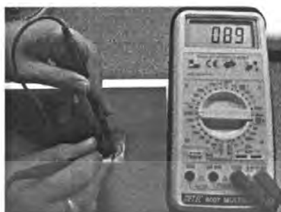
(b) หลังแอนนีสอ่านค่าความต้านทาน ได้ 89 MΩ
