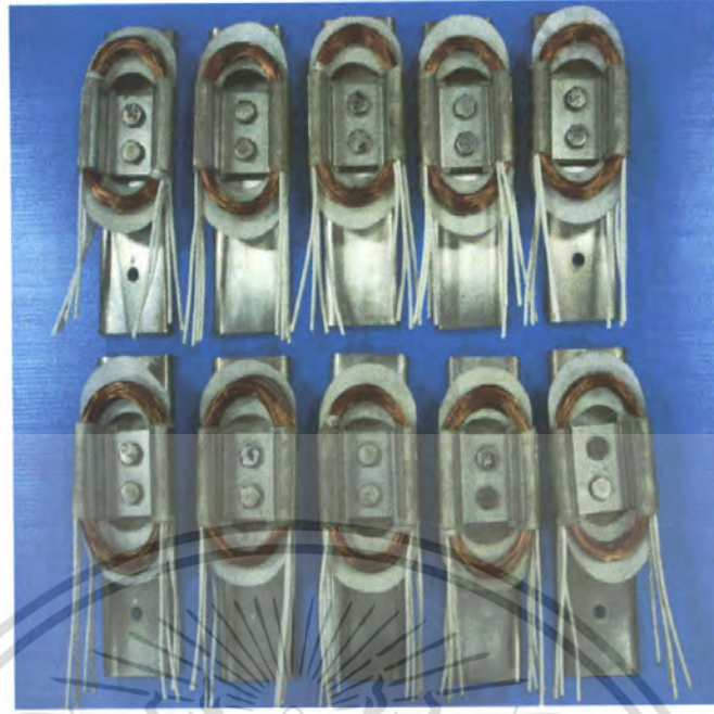
รูปที่ 5.2 แบบจำลองร่องสลีตที่ใช้ในการทดสอบ
