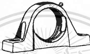
รูปที่ 3.19 ตัวเสื้อแบบพลัมเมอร์ (พิด โด) บล็อกขึ้นเคียวทำด้วยเหล็กหล่อ
