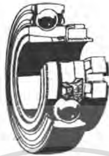
รูปที่ 3.17 แบบปลอกปรับขนาดเพลลา
