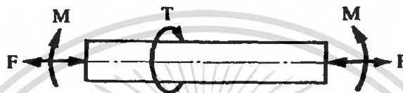
รูปที่ 3.1 เพลลาอยู่ภายใต้แรงต่างๆ
