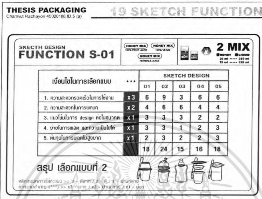
ภาพที่ 4.1.19 แผนภาพแสดง ตารางการเลือกแบบในด้านการใช้งาน โครงสร้าง s01
