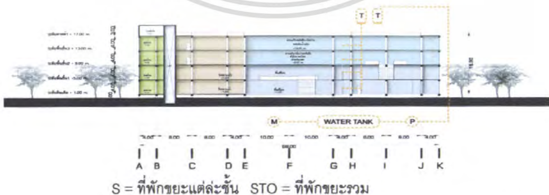
ภาพที่ 3.22 Diagram ระบบกำจัดขยะของอาคารหอจดหมายเหตุแห่งชาติ
