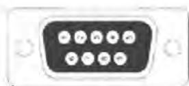
รูปที่ 2.11 DB9 ตัวผู้ เมื่อดูจากด้านหลัง
